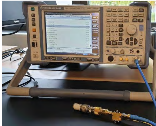
Abbildung 3-3: Kalibrierung des Messsystems
